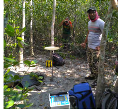
3 Exemple d'un point de mesure réalisé dans la forêt des Sundarbans. Le couvert végétal est extrêmement dense. Nous choisissons des sites où ce dernier est moins dense afin que l'antenne GNSS capte un nombre suffisant de satellites, les arbres limitant le passage des ondes. Pour des raisons de sécurité, nous devons rester extrêmement groupés et à moins de quelques mètres des gardes forestiers armés qui nous accompagnent, car nous sommes sur le territoire d'un grand prédateur, le tigre du Bengale dont nous avons souvent croisé les traces. Crédits : C. J., Grall.
