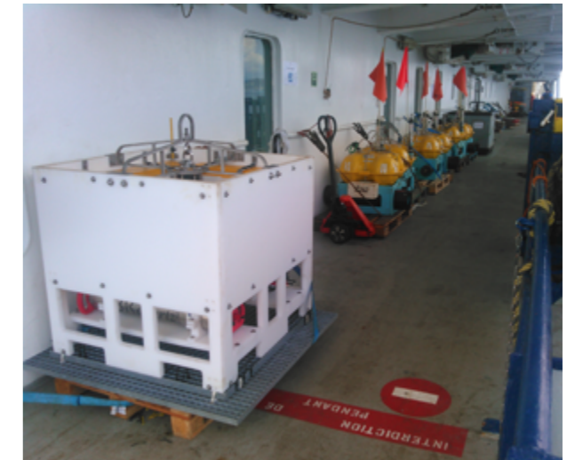
1- Le capteur A0A Résif et OBS Insu-IPGP prêts à être déployés sur le pont. Crédits : Denis Dausse, Mayobs15 - Revosima 2020
