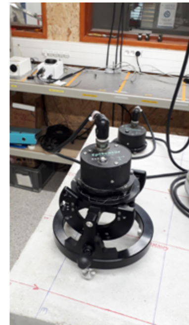
3 – Bascule - Test des capteurs accélérométriques à Grenoble - Crédits : Corallie Aubert
