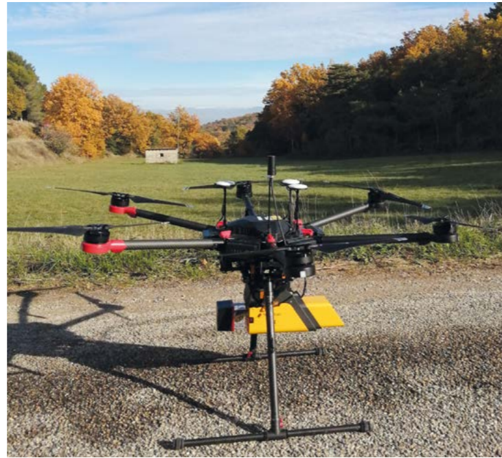
3 - Campagne microtopographique par LiDAR sur la rupture de surface du séisme du 11 novembre 2019 au Teil. Le drone hexacoptère équipé du système LiDAR YellowScan VX (boîtier jaune) à son décollage du Quartier Lebeau au sommet de la Rouvière (commune du Teil). Photo : Marie de Boisvilliers, L'Avion Jaune
