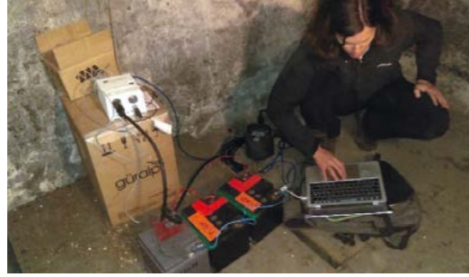
1 - La station TEIL en cours de paramétrisation dans la cave de la mairie par Diane Rivet. Photo : Anne Deschamps
