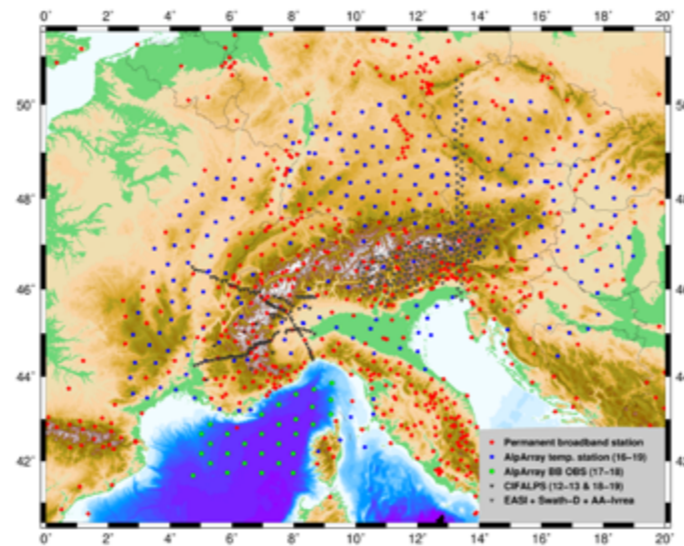
1 - Carte des stations temporaires et permanentes installées dans les Alpes pendant le projet AlpArray (voir légende carte) - Crédits : Anne Paul
