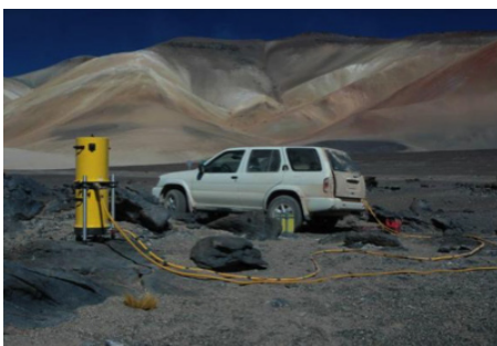
Gravimètre absolu A10 en opération de terrain dans les Andes chiliennes (4500m).
