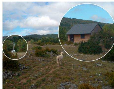
*future station permanente de RESIF. A l'extérieur, deux pluviomètres au auget et une tour de flux (zoom de gauche) permettent d'obtenir des mesures météorologiques précises et locales.*
