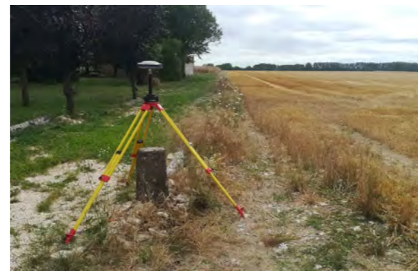
3- Mesure RTK de la position d'une borne du réseau RDF de l'IGN dans la zone de La Laigne par les équipes du LIENS en juillet 2023. Crédits Médéric Gravelle
