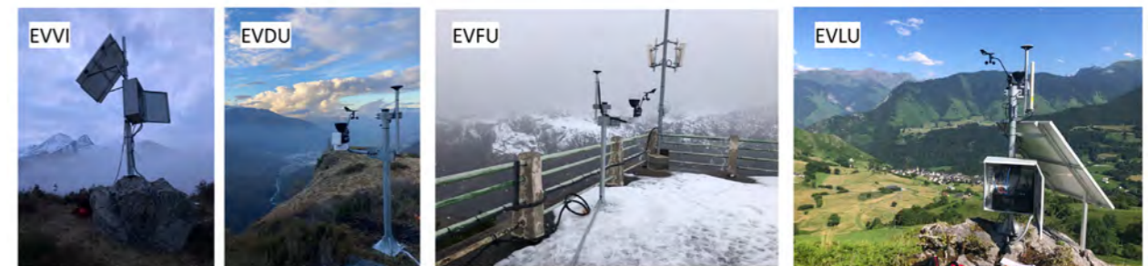
2- Station de mesures multi-paramètres co-localisées associant récepteur et antenne GNSS, station météorologique et capteur sismologique : exemple des stations EVVI (Villalongue), EVDU (Sarrance), EVDU (Barèges) et EVLU (Lescun). © CNRS/EOST - Jean-Philippe Malet
